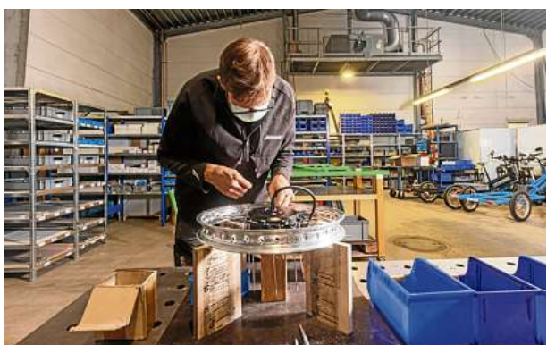
Mitarbeiter Hilmar Jaedicke montiert in der Produktionshalle Speichen an einem Rad für das Tricargo-Lastenrad Lademeister.
